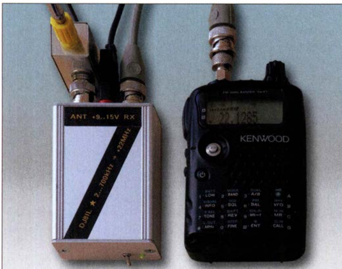
Bild 1: Musteraufbau des LF/VLF-Konverters im Aluminium-Kleingehäuse mit angeschlossener Aktivantenne; das Handfunkgerät mit KW-Empfangsbereich ist auf 22 MHz zuzüglich Empfangsfrequenz eingestellt. Aufgrund der hohen Oszillatorstabilität driftet die Frequenz beim stationären Betrieb nur um wenige zehn Hertz.
