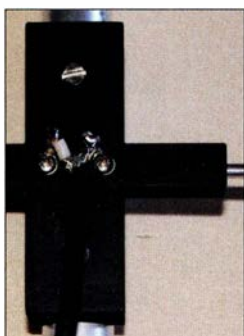
Bild 12: Dipol-Mittelleil von DL1HUB aus dem 3-D-Drucker, Deckel abgenommen, nur rechte Seite dargestellt
