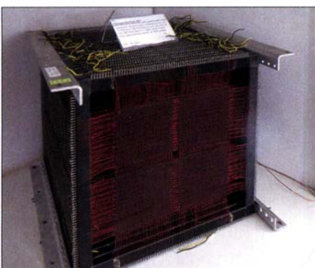
Bild 5: Kernspeicherblock mit vier Feldern zu je 50 x 50 Kernen, 18 Ebenen zu je 1000 Kernen, also insgesamt 180 000 Magnetkernen
