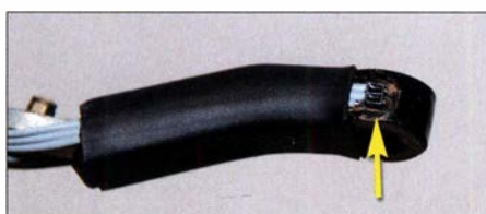
Bild 4: Mit Schrumpfschlauch überzogener Tastenhebel; am Tastenkopf ist eine der beiden Lichtschranken gut zu erkennen.
