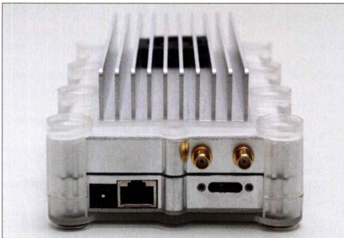
Bild 2: Der Sigma erfasst bis zu 64 MHz mit 16 Bit Auflösung in einem Rutsch – einschließlich Aufnahmen und Abspielen „wie live“; hier ist der Bereich von 0 bis 32 MHz zu sehen.
