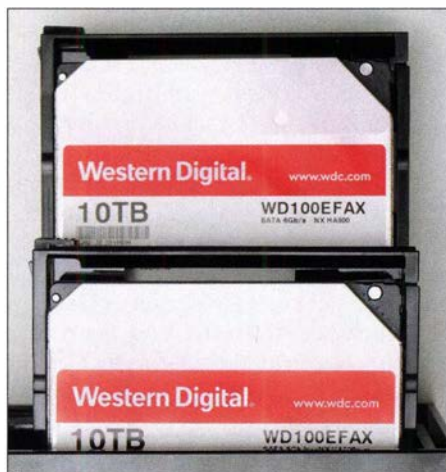
Bild 9: Der Sigma ist ein Datenfresser mit Speicherbedarf im Terabyte-Bereich. Eine externe Festplatte wie die hier gezeigte preiswerte My Book Duo mit 2 × 10 TB in RAID0 schafft erst einmal genügend Raum.
